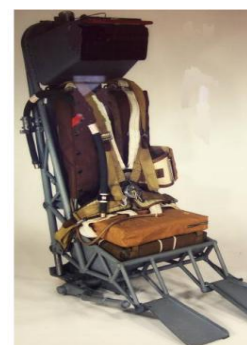
L'ensemble du siège Martin-Baker Mk 1 pesait environ 78 kg dont 64 étaient éjectés. Le parachute était derrière le dos du pilote, et un kit de survie sous ses fesses.
