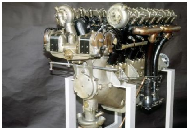
Moteur Renault refroidi par eau homologué en 1917, en service en 1918 (Breguet XIV). 12 cylindres en V, 22,10 L, 305 CV à 1550 tr/mn, 380 kg. ⇨
